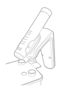
Pour une lecture optimale en mode RFID, il est important de positionner l'antenne RFID présente sur la face avant du FISHGUN D2, juste en face de la puce RFID.
