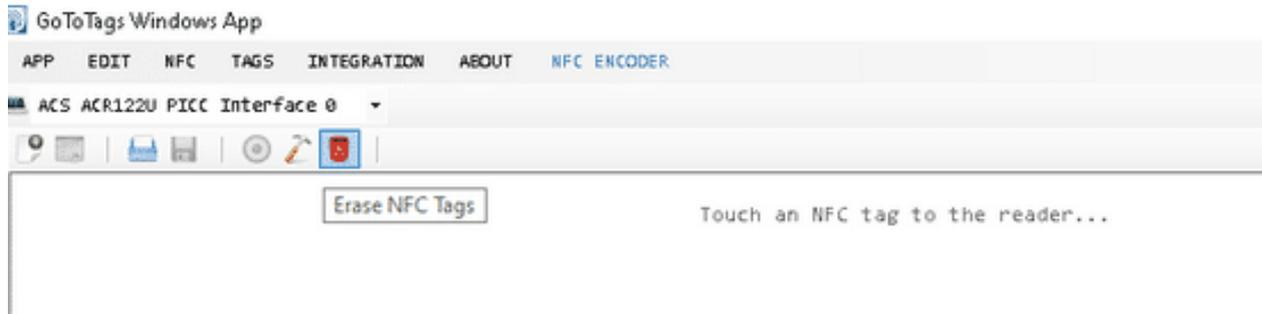
Puis comme pour l'écriture, une fenêtre va s'ouvrir. Apposez la puce à déprogrammer sur le boîtier et attendez que le logiciel confirme la déprogrammation.
