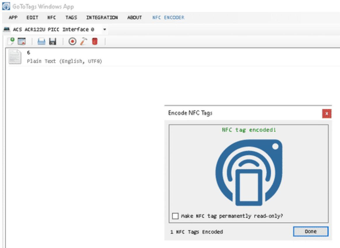
Votre puce RFID est à présent bien programmée et lisible par le FISHGUN. De cette manière, il est possible de programmer plusieurs puces avec le même nombre de poissons à nourrir. Sinon, il suffit d'effacer les données entrées dans le boîtier à l'aide de l'icône "Clear all records".
