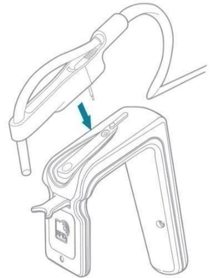
Afin que le support du tube reste dans la bonne position, veiller à ne pas renverser le FISHGUN lors de l'utilisation, et ne pas faire de mouvements brusques.
