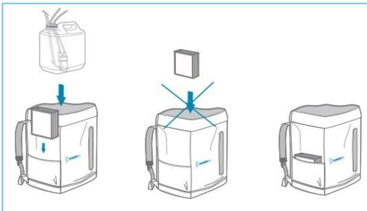
La capacité maximale du réservoir est de 5 litres, par ailleurs, nous conseillons de ne pas remplir au-dessus de 4,5 litres afin d'éviter tout débordement pendant le transport
